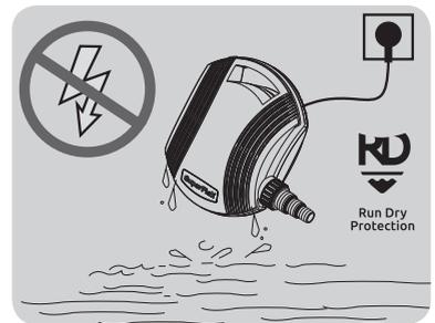
In het geval van oververhitting van de pomp heeft deze een thermische beveiliging tegen overbelasting. In het geval van oververhitting van de motor, schakelt het apparaat automatisch de pomp uit. De afkoeltijd bedraagt ongeveer 15 tot 20 minuten, dan wordt de pomp automatisch weer ingeschakeld. Als de motorbeveiliging is geactiveerd, is het essentieel te onderzoeken wat de oorzaak is van de oververhitting en deze op te lossen.
