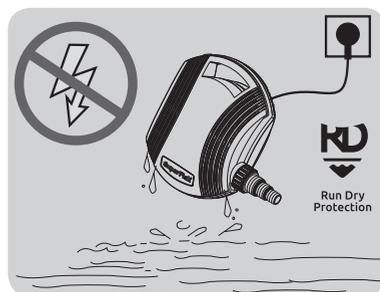
La pompe est munie d'une protection thermique. En cas de surchauffe éventuelle du moteur, la protection intervient en éteignant automatiquement la pompe. Le temps de refroidissement est d'environ 15-20 min puis la pompe se rallume automatiquement. Après l'intervention de la protection thermique, il faut absolument en identifier la cause et l'éliminer.
